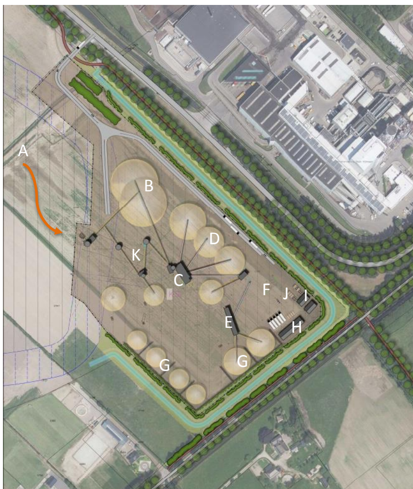
Afbeelding 3 Belangrijkste onderdelen van de KSI
