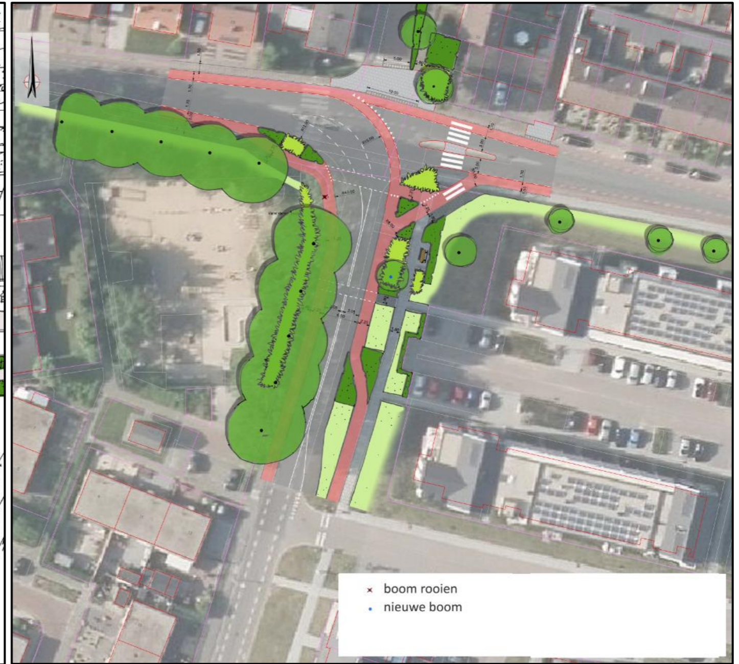
Figuur 2: Bovenaanzicht variant voorrangsbocht
